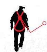
Queda FATOR 1 ponto de ancoragem situado ao mesmo nível do ponto de ancoragem
