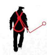
Caduta FATTORE 1 punto di ancoraggio situato sullo stesso livello del punto di ancoraggio dorsale dell'imbracatura
