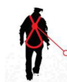
Queda FATOR 2 ponto de ancoragem situado a baixo da conexão dorsal do arnês
