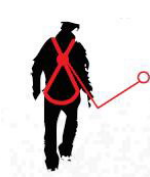
Caída FACTOR 1 punto de anclaje situado al mismo nivel del punto de anclaje dorsal del arnés
