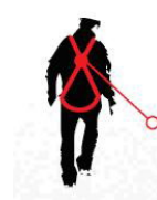
Caduta FATTORE 2 punto di ancoraggio è situato sotto il punto di ancoraggio dorsale dell'imbracatura
